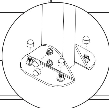
FR : Mettre les caches écrous sur l'ensemble des écrous
